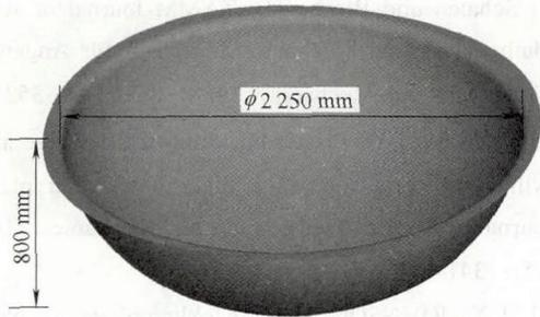
图8 火箭贮箱箱底充液拉深成形数值模拟预测
