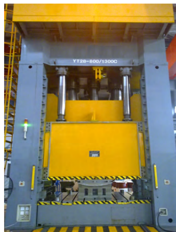
图 18 哈尔滨工业大学研制的 13 000 kN 双动板材液压成形设备
