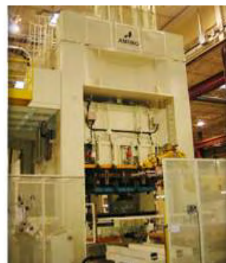
(a) 日本 Amino 公司 30 000 kN 板材液压成形机
