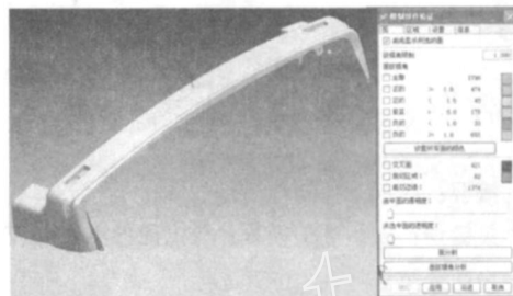
图3 制件的拔模分析
