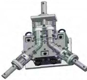
图8 1模2腔45°弯管件注塑模动模三维图
