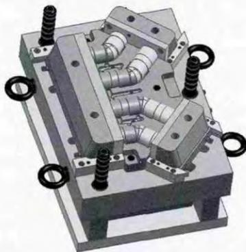
图5 1模4腔45°弯管件注塑模动模三维图
